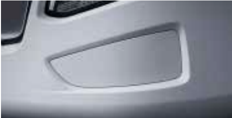
Capteurs radar avant (montés sur le pare-chocs)
