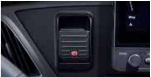
Frein de stationnement électronique (EPB) Le frein de stationnement s'active facilement en tirant simplement sur le levier, ce qui garantit confort et sécurité, avec la fonction Autohold en plus.
