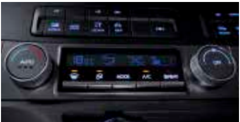
Commandes de climatisation Les fonctions de chauffage, ventilation et climatisation sont désormais plus faciles à utiliser grâce à l'écran LCD.
