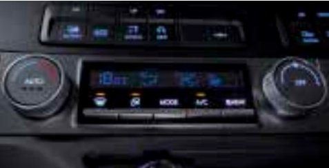
Commande de climatisation
